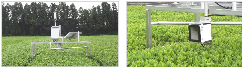
図1 開発した可動式LPWA静止画監視システム（子機）
