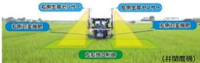
前方の生育センサーで稲の生育量を測定し、その生育データに基づきリアルタイムに最適量の施肥(追肥)を計算。計算結果に基づき、後方の施肥機での散布量を可変制御。
