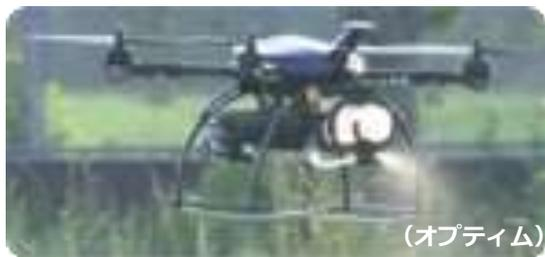
自動飛行によりほ場全体を撮影し、AIを用いた画像解析により、害虫の位置を特定。害虫の位置まで自動飛行し、ピンポイントで農薬を散布。
