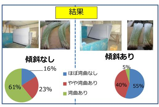
乾燥箱の背もたれ板を可動式に改良し、乾燥途中に乾燥箱の背もたれ板を段階的 (6時間後に15度、10時間後に30度)傾斜させることによって、いぐさの湾曲 程度を有意に低下させることができた。
