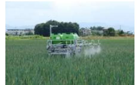
ねぎの自動農薬散布ロボット
