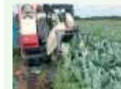
鉄コンテナを搭載した自動収穫機で一斉収穫し、鉄コンテナで貯蔵・出荷
